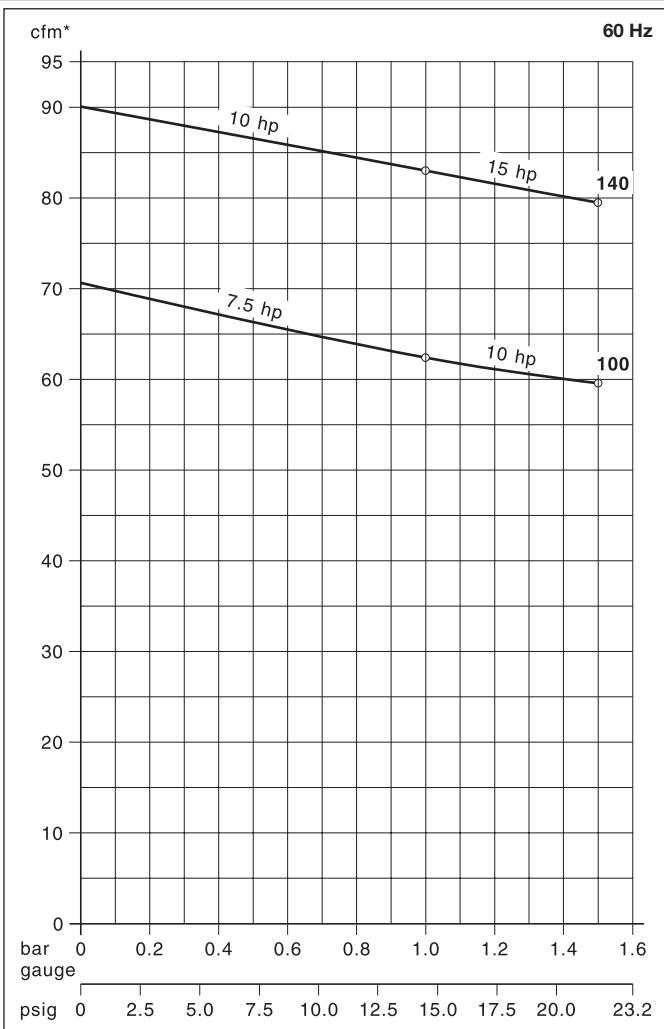
\* Capacity refers to free air at 1 standard atmosphere and 20° C (68° F). / La capacidad se refiere al aire libre a 1 atmósfera estandar de presión y a 20° C (68° F) de temperatura./ Le débit est mesuré à l'atmosphère de 1 bar (abs.) à 20° C (68° F). / A capacidade refere-se ao ar livre a uma atmosfera padrão 1 e a 20° C (68° F).
