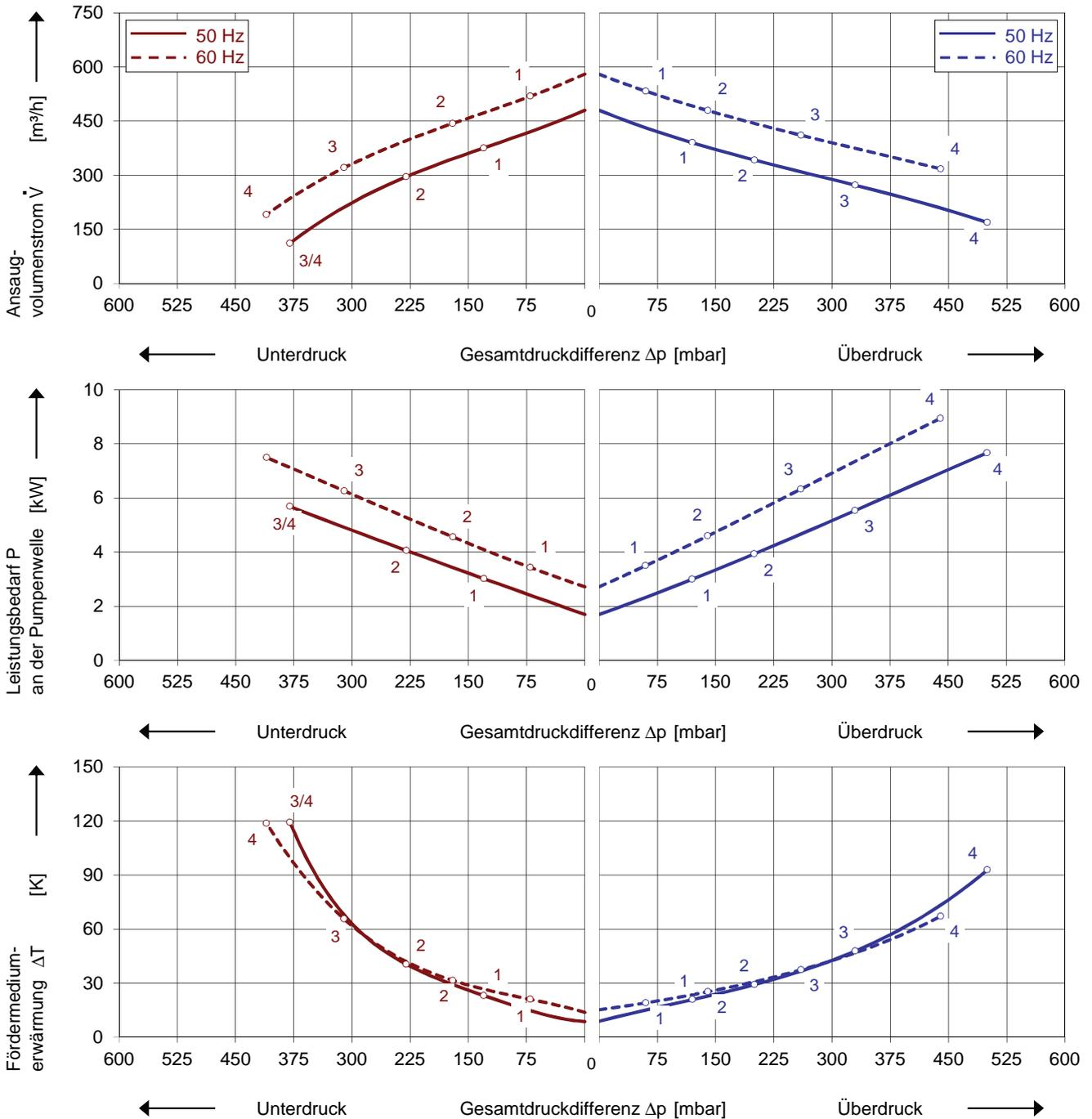
Die Kennlinien gelten für Fördermedium Luft von 15 °C und Atmosphärendruck von 1013 mbar mit einer Toleranz von ± 10 %. Die maximal im Dauerbetrieb zulässigen Gesamtdruckdifferenzen gelten bis zu einer Ansaug- und Umgebungstemperatur von 25 °C. Bei anderen Bedingungen bitten wir um Rücksprache.
