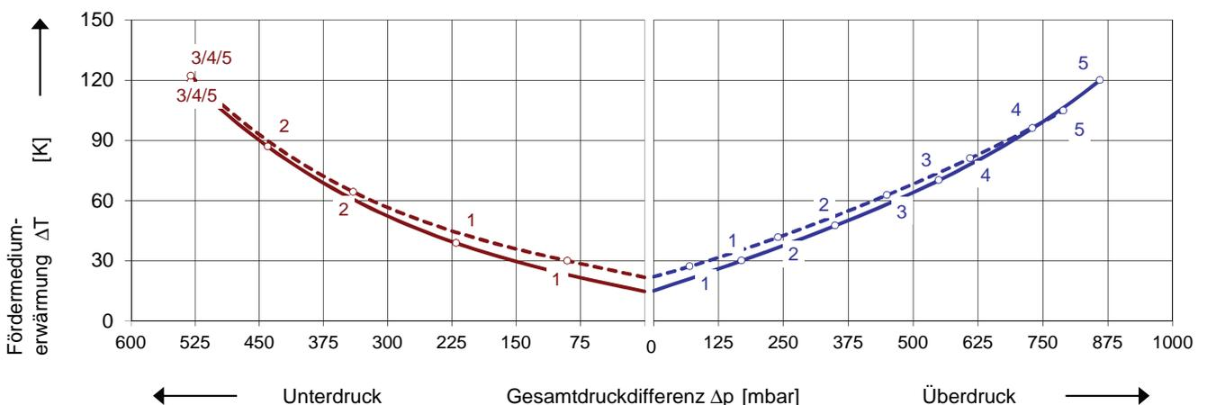
Die Kennlinien gelten für Fördermedium Luft von 15 °C und Atmosphärendruck von 1013 mbar mit einer Toleranz von  $\pm 10\%$ . Die maximal im Dauerbetrieb zulässigen Gesamtdruckdifferenzen gelten bis zu einer Ansaug- und Umgebungstemperatur von 25 °C. Bei anderen Bedingungen bitten wir um Rücksprache.
