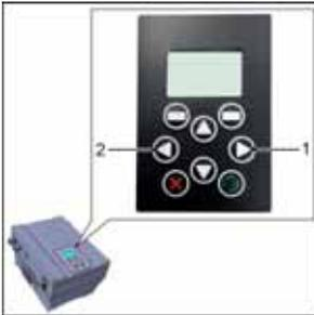
3. Zur Aktivierung der Diagnoseschnittstelle ist es notwendig das "MMI im Deckel" in den Standby Modus zu versetzen.
