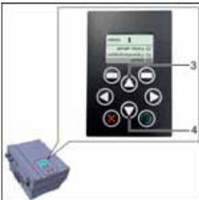
3. Es besteht auch die Möglichkeit mit dem "MMI im Deckel" das Display um 180° zu drehen.
